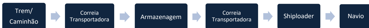
Figura 1 – Fluxograma da operação de embarque de granéis vegetais. Fonte: Plano Mestre do Porto de Paranaguá (2018).
